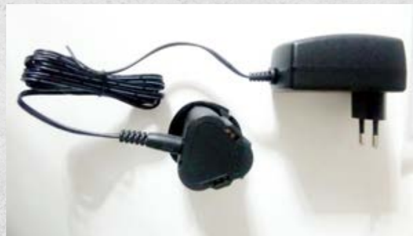
Бестрансформаторное моноблочное зарядное устройство с током заряда 1,5 А
