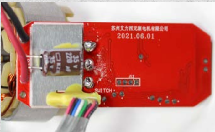
На плате управления снизу видны контакты для подключения программатора. Клипса выключателя залита клеем. Стоит пластина под транзисторами и выполняет функцию аккумулятора тепла. Кроме того, она препятствует деформации платы
