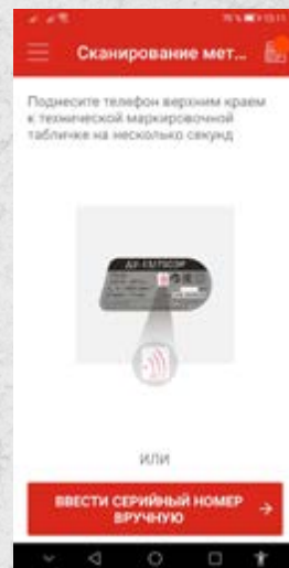
В боковой шильдик встроена электронная метка, в которую «вшита» вся основная информация о данной модели. Метка (МСТ) легко читается обыкновенным смартфоном при активации функции NFS
