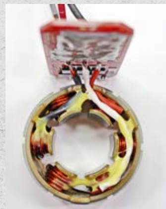
Статор на 6 катушек из медной проволоки, покрытой лаком
