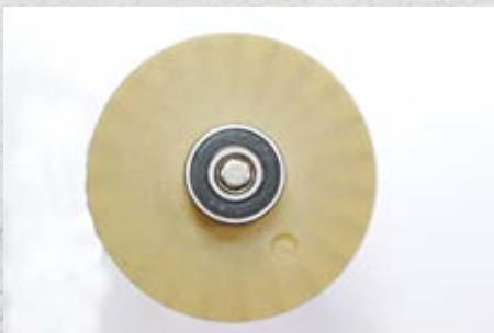
Виден задний опорный шариковый подшипник ротора двигателя с маркировкой XAJ 695RS
