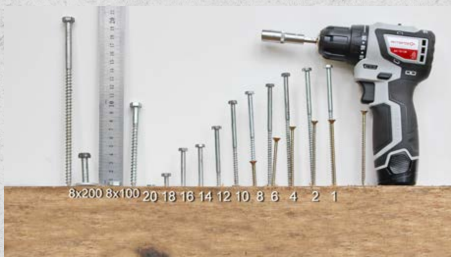
Диапазон настройки муфты регулировки крутящего момента плавный и довольно широкий, позволяющий работать с крепежом различного размера
