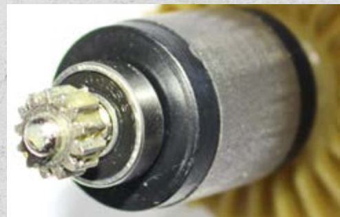
Ведущая шестерня на валу ротора двигателя – виден передний опорный шариковый подшипник ротора двигателя XAJ 695RS и крыльчатка охлаждающего вентилятора
