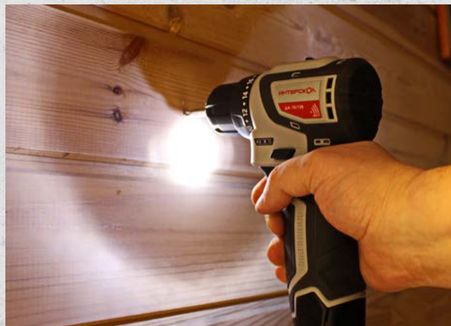
Достаточно яркая LED-подсветка рабочей зоны расположена над кнопкой выключателя и светит чуть ниже центра биты
