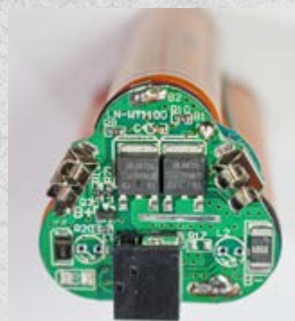
Плата управления и контактные группы стандартные на 4 точки. Два силовых транзистора типа IRLR8726 способны передать до 150 Вт мощности
