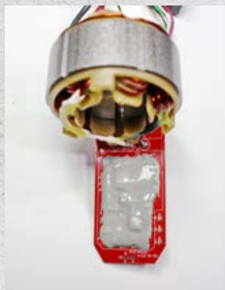
На силовой плате управления, с правой стороны, видны диоды индикации степени заряда аккумулятора, плата герметично залита силиконовым герметиком
