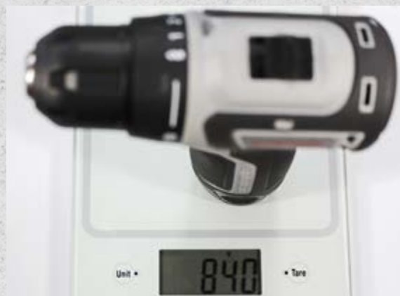
Вес инструмента с аккумулятором - всего 840 гр., тогда как сама батарея весит 179 гр.
