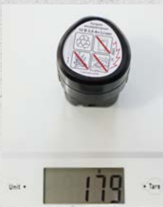
Вес инструмента с аккумулятором - всего 840 гр., тогда как сама батарея весит 179 гр.
